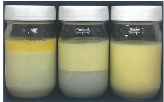
油浮き状態 60L 0.1%配合 60L 0.2%配合 *油剤: シュガースクワラン (炭化水素系)
