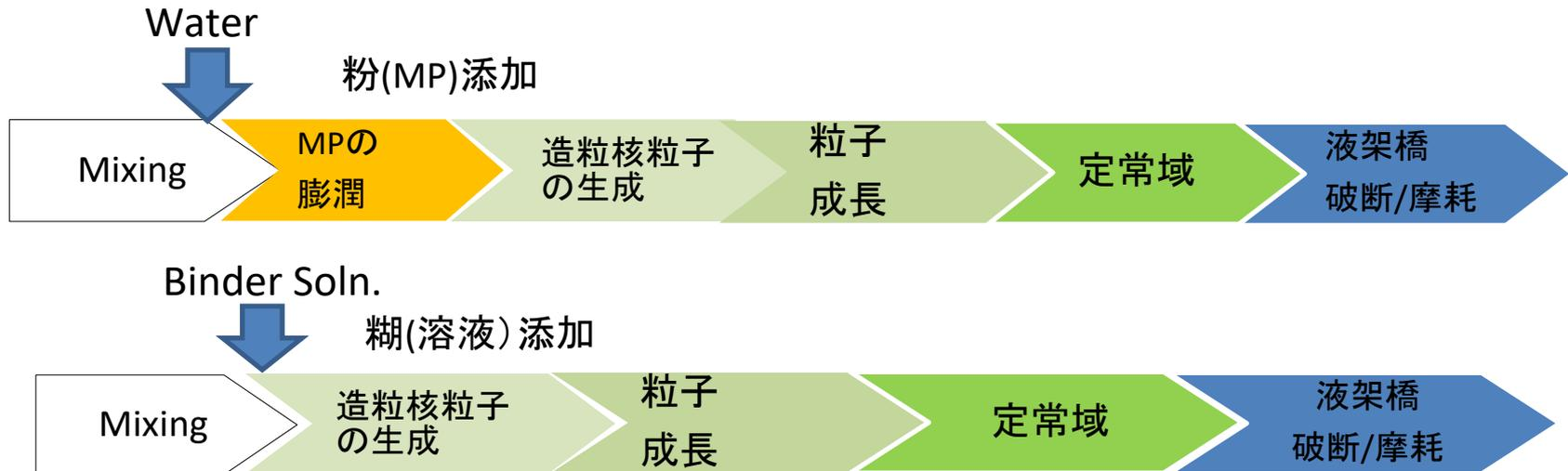
操作条件:  $\sim 50\text{rpm} \times 30\text{min} = \theta$  (湿塊の転動回数に相当)1500)
